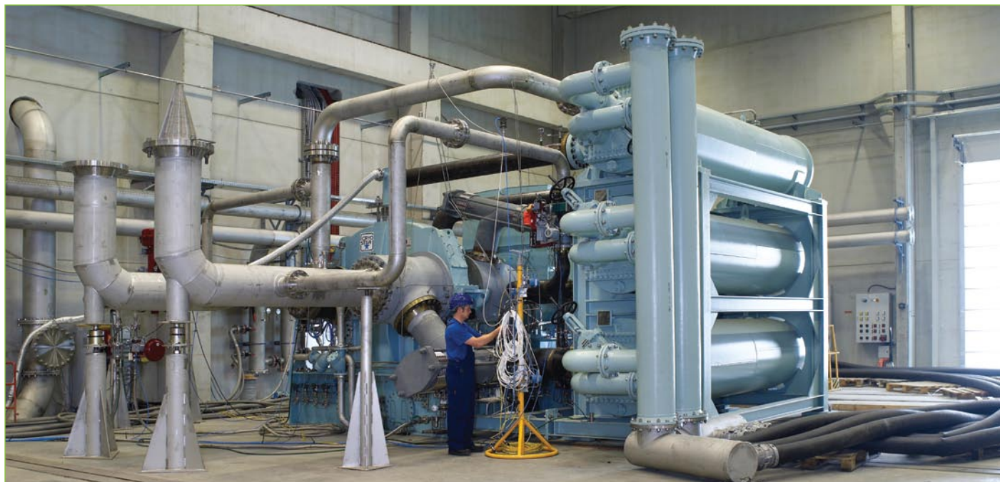
压缩膨胀机 将膨胀机和压缩机组合成一台机器，结合齿轮的设计和安装在制冷循环里。
